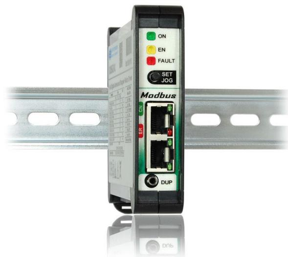
Il layer fisico è di tipo **RS485** e isolato dall'alimentazione ausiliaria e di potenza, la velocità di comunicazione raggiunge **921,600Kbit/s**. Tra le funzioni implementate c'è la Lettura/Scrittura di Registri Multipli (**23 0x17 Read/Write Multiple registers**) che consente in un'unica transazione di leggere e scrivere più registri contemporaneamente e può essere sfruttata ad esempio per aggiornare il set point di posizione e leggere la quota dell'encoder in un'unica operazione.
