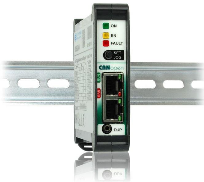
Gli azionamenti serie **DDS6** sono realizzati con tecnologia completamente digitale e sono adatti al pilotaggio di motori passo-passo a due fasi.
