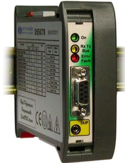
Gli azionamenti per motori passo-passo a due fasi appartenenti alla serie DS5x sono composti da 27 modelli diversi suddivisi in 9 taglie di potenza e 3 differenti tipi di interfaccia: DS50→RS485, DS52→RS232, DS54→USB. L'interfaccia di comunicazione è isolata dall'alimentazione di potenza e dai segnali logici per garantire affidabilità ed immunità ai disturbi.
